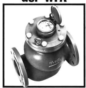
Zähler mit senkrechtem, speziellem Lamellen-Flügelrad. Daher sehr gute Messresultate bei kleiner Belastung. Waagrechter Einbau, herausnehmbarer Messeinsatz. Nennweiten 50, 65, 80, 100 und 150 mm. Verwendung: Grossabnehmer mit stark schwankendem Wasserverbrauch, wie Hotels, Spitäler, Industriebetriebe usw.
