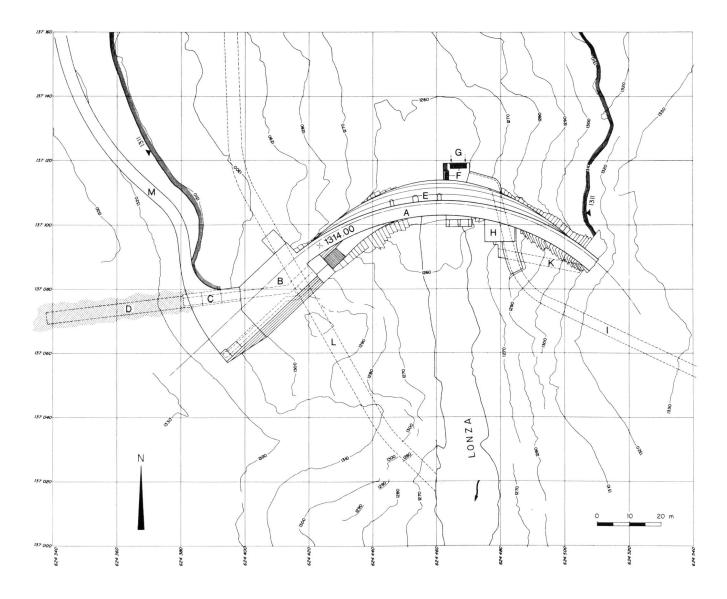
Bild 1. Uebersichtsplan der Bogenstaumauer Ferden 1:1200. A Bogenmauer (Höhe 67 m, Kronenlänge 101 m, Volumen 28 200 m³), B künstliches Widerlager (Höhe 33 m, Breite 17 m, Länge 22,6 m, Volumen 8000 m³), C Betondiafragma, D Lockergesteinsinjektion, E Hochwasserentlastung (Freiüberfall 110 m³/s), F Wasserfassung, 20 m³/s, G Grundablässe, 2 x 110 m³/s, H Drosselklappenkammer, I Druckstollen, K Drainagestollen, L Umleitstollen, M Zufahrtstrasse.
