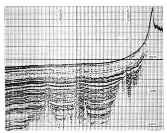
Bild 3. Profil von Richterswil (links) gegen Bächau. Im Ostteil (links) hart gelagerter, unruhig verlaufender Untergrund aus Lockergesteinen. Rechts aussen die Unterwasserbaggerung zur Kiesgewinnung. Darüber nahezu horizontal eingeschichtete, weiche, junge Sedimente mit differentiellen Setzungen.
