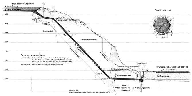
Bild 12. Rodundwerk II — Druckschacht, Längsschnitt.
