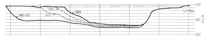
Bild 1a. Querprofil durch den Bodensee vom Rhein-km 90 bis Lindau. Längen 1:40 000, Höhen 1:4000. Seit der Eröffnung des Fussacher Durchstiches im Jahre 1900 hat sich die Rheinmündung im Bodensee um rund 2 km vorgeschoben. Ein Weiterwachsen des Deltas quer durch den See in Richtung Lindau muss verhindert werden.
