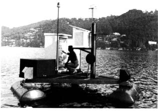
Die automatische schwimmende Messstation auf dem Luganersee
