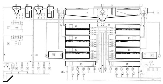
Bild 12. Schema der neuen Aufbereitungsanlage, als Blindschema mit aktiven Bedienungs- und Signalelementen im Kommandoraum ausgeführt (siehe auch Bild 11).
