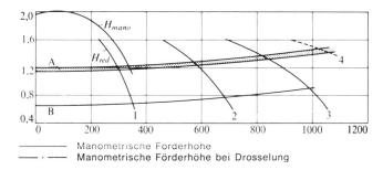
Bild 13. Pumpenkennlinien beim Einzelbetrieb der neuen Anlage. 1 bis 4 Kennlinien der Reinwasserpumpen (oben) und der Rohwasserpumpen (unten); H<sub>mano</sub> Manometrische Förderhöhe, H<sub>red</sub> Manometrische Förderhöhe bei Drosselung; A Zulässiger Druckbereich, B Kennlinie der Rohwasser-Saug- und -Druckleitungen.
