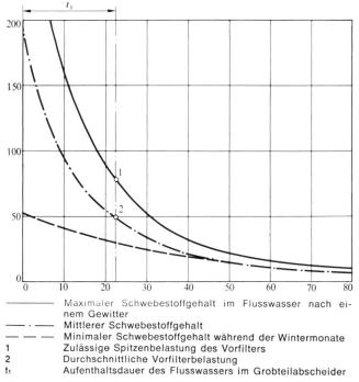
Bild 2. Absetzkurven für im Flusswasser enthaltene Schwebestoffe. Durch die zulässige Vorfilterbelastung wird die erforderliche Grösse des Grobteilabscheiders bestimmt.
