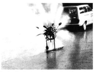
Hochdruckdüsen-Batterie zum Reinigen von Druckstollen und Druckleitungen. Um die Wirkungsweise zu zeigen, wurde die Anlage hier im Freien aufgebaut. Die Düsen können für runde Rohre bis 2 m Durchmesser angepasst werden. (Photo OBAG)
