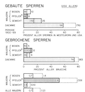
Bild 4. Auswertung der Talsperrenbrüche nach Konstruktionstypen.
