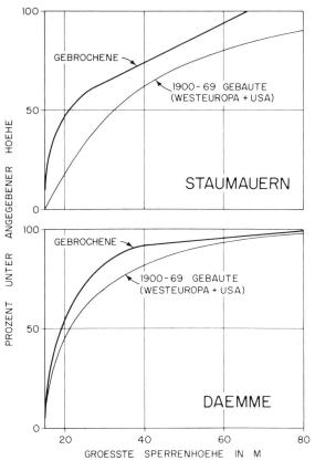
Bild 3. Auswertung der Talsperrenbrüche nach Sperrenhöhen.
