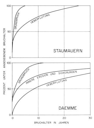
Bild 2. Auswertung der Talsperrenbrüche nach dem Bruchalter.
