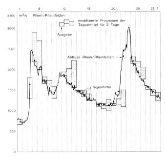
Bild 6 Rhein bei Rheinfelden. Kurzfristprognosen für den Abfluss. Vorhergesagte Tagesmittel des Ausgabetages und der beiden nächstfolgenden Tage (unterer Wert mit 90 %, oberer mit 10 % Ueberschreitungswahrscheinlichkeit), im Vergleich zu den beobachteten Werten. Abflussganglinie des Februars 1970.
