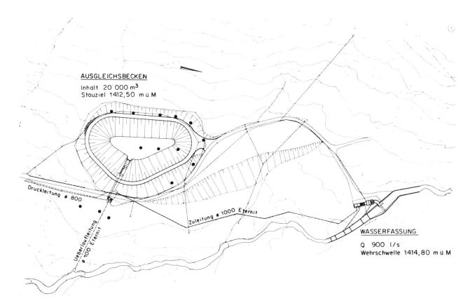
Bild 2 Anlagen auf der Alp Gneida. Wasserfassung mit Einlaufwerk, Entsanderkammer und Ueberlaufleitung, Zulaufleitung (300 m lang), Ausgleichbecken. Uebersicht etwa 1:3000. Die Punkte geben die Lage der Filterbrunnen an; Brunnendurchmesser 350 mm, Bohrungsdurchmesser 900 mm.
