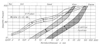
Bild 5 Summationskurve der Kornverteilung des Moränenmaterials für die Dichtungszone und für den Filteraufbau.
