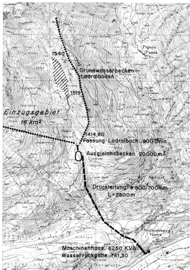
Bild 1 Uebersichtsplan über die Anlagen des neuen Kraftwerks Ladrall; Ausnützung des Ladrallbaches als Einstufenwerk mit Fassung auf Kote 1414,80. Ausschnitt aus der Schweizerischen Landeskarte 1:25 000, verkleinert auf 1:50 000, reproduziert mit Bewilligung der Eidg. Landestopographie vom 1. März 1976.
