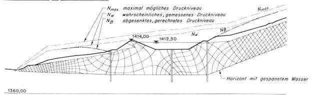
Bild 4 Schnitt 1:2000 durch das Ausgleichbecken Gneida mit Sickernetz und Druckniveau des gespannten Grundwassers.
