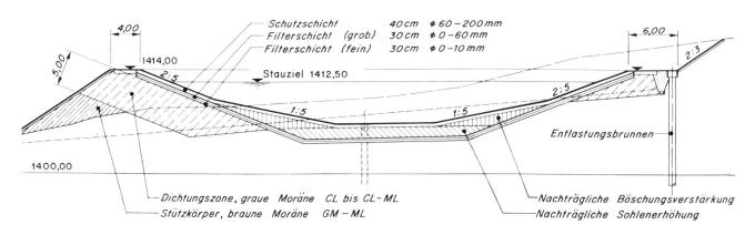
Bild 3 Schnitt rund 1:580 durch das Ausgleichbecken Gneida, Beckenaufbau mit Angabe der eingebauten Schichten und Materialien.
