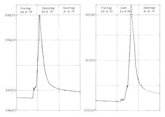
Bild 4 Wasserstandsganglinien gemass den Limnigraphenstreifen der Stationen Huttwil (Häberenbad), links, und Lotzwil, rechts, an der Langete. Im rechten Diagramm wurde die Spitze nach Hochwasserspuren ergänzt.
