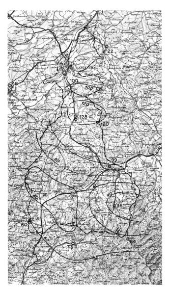
Bild 2 Einzugsgebiet der Langete, Landeskarte der Schweiz im Massstab 1:100 000 (verkleinert auf 1:200 000). Eingetragen sind die Niederschlags-Isolinien 20 zu 20 mm für 29./30. August 1975. Reproduziert mit der Bewilligung der Eidg. Landestopographie vom 1. März 1976.
