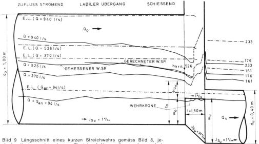
Bild 9 Längsschnitt eines kurzen Streichwehrs gemäss Bild 8, jedoch mit einer extrem kurzen Streichwehrlänge, die nur dem anderthalbfachen Durchmesser des Zuflussrohrs entspricht. Es wurden verschiedene Beaufschlagungen bis zur zehnfachen Grenzwassermenge untersucht. Das Ergebnis dieses und anderer Versuche soll der Praxis etwa Ende 1976 zur Verfügung gestellt werden.
