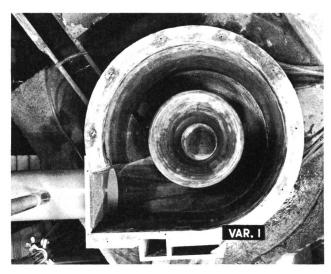
Bild 6 Tulpenförmige Regenwasserentlastung, Variante mit tangentialem Zulauf. Trockenwetterrinne am Schachtfuss und Dosieröffnungen in der Schachtwand. Maximaler Mischwasseranfall in Natur: 92 m³/s (Projekt: Ingenieurunternehmung AG Bern für die Anlage Eichholz in Bern) [7].
