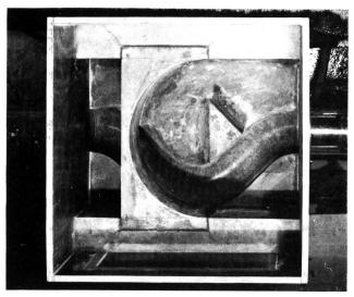
Bild 10 Wirbelkammer. Zulauf von links, Auslauf nach rechts Schlangenförmige Trockenwetterrinne. Trennkeil für Mischwasser Halbkreisförmige Leitwand, die bei Verstopfung des unter ihr angebrachten Durchlasses überströmt wird.
