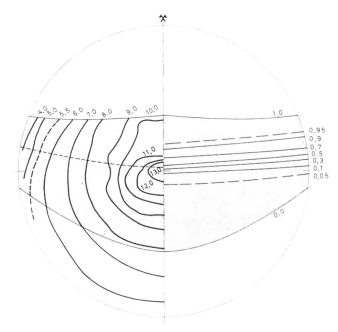
Bild 4 Auswertungsbeispiel der Messungen an der Hauptversuchsanlage. Der Abfluss erreicht 200 I/s (Wasser), das Gefälle 20,5 %, der Messquerschnitt befindet sich 37,5 m unterhalb des Rohreinlaufs bzw. der kritischen Abflusshöhe. Die mittlere Strömungsgeschwindigkeit beträgt 9,3 m/s. In der linken Bildhälfte sind die Isotachen (m/s) und strichliert die mittlere Gemischoberfläche eingezeichnet. In der rechten Bildhälfte sind die Linien gleicher Luftkonzentration dargestellt.
