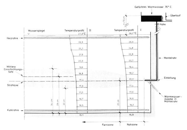
Bild 12 Längsschnitt durch die Versuchsanlage zur Nachbildung des Einschichtungsvorganges. Darstellung der Temperaturgradienten im Behälter und der Ausbreitung des gefärbten Warmwassers des Versuchs gemäss Bild 13.
