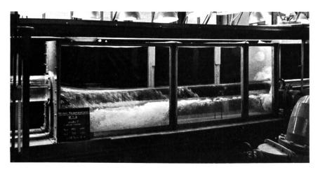
Bild 5 Zweiseitig entlastendes Streichwehr mit niedrigen Ueberlaufschwellen. Die Streichwehrlänge entspricht dem zwölffachen Durchmesser des Zuflussrohrs, die Beaufschlagung der zehnfachen Grenzwassermenge [4].
