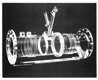
Bild 2 Versetzbarer Messquerschnitt für die Hauptversuchsanlage mit 240 mm Innendurchmesser. Die vordere und höhergestellte Sonde dient der Geschwindigkeitsmessung, als Gegenelektrode dient das Metallband am Rohrumfang links vom Fuss dieser Sonde. Die hintere und tiefergestellte Sonde ermittelt die örtliche Luftkonzentration des Gemisches. Die schwach sichtbare Messharfe über den Rohrquerschnitt rechts der beiden Sonden dient der Bestimmung der Gemischoperfläche
