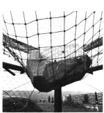
Bild 4 Versuchsblock im Versuchsnetz. Mit Betonklötzen von 200 kp und 1000 kp wurden Fallversuche durchgeführt, wobei die Fallhöhe bis 20 m gesteigert wurde.
