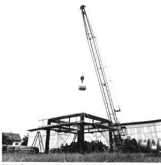
Bild 3 Der eigens dafür gebaute Gerüstbock im Areal der Drahtseilfabrik mit montierten Versuchsnetzen aus Drahtseilen. Das Fallgewicht von 1000 kg wird mit einem fahrbaren Kran auf bis 20 m über die horizontale Netzebene gehoben und ausgeklinkt. Nach jedem Versuch werden alle Veränderungen an Netzen, Seilen, Befestigungen und insbesondere an Bremselementen protokolliert und ausgewertet.
