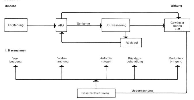
Bild 1 Funktionsmodell der Schlammentwässerung im Rahmen der gesamten Kläraufgabe.
