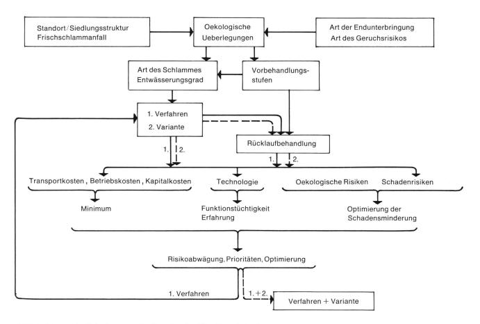
Bild 2 Schema der Ueberlegungen für die rationelle Klärschlammbehandlung.
