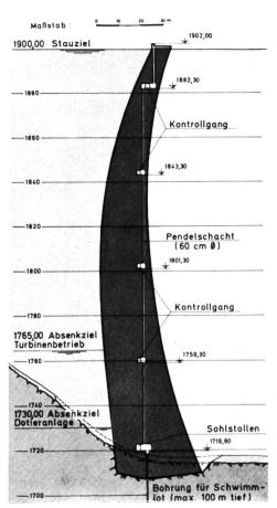
Bild 6 Querschnitt durch die 198 m hohe Bogenstaumauer.
