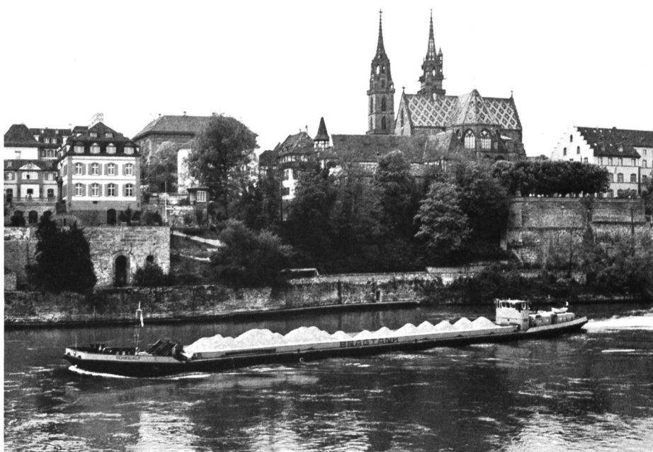
Bild 1 Das Basler Münster dominiert den Rhein. Baumaterialtransport MS Schwägalp, selbstlöschendes Spezialschiff der Bragtank AG (2000 t, 1100 PS).
