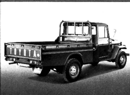
Toyota Land Cruiser Pick Up 3 Plätze, Nutzlast 1210 kg, Brückenlänge innen 2135 mm, Brückenbreite innen 1590 mm. Fr. 21 700.— Fr. 22 250.— mit Blache Fr. 22 950.— mit Blache und Bänken
