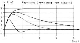
Bild 4 P- und Pl-Regelung: Abhängigkeit der Sprungantworten in einer Stauhaltung von der Wahl der Regelparameter.
