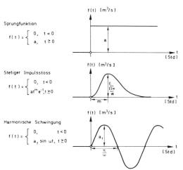
Bild 3 Beispiele von Zufluss-Testfunktionen.
