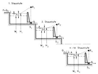
Bild 6 Kaskade: Ein vereinfachtes Modell einer Stauwerkkette von n Stufen
