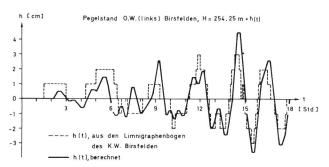
Bild 9 Simulation der Stauregulierung vom 8. August 1972 beim Kraftwerk Birsfelden
