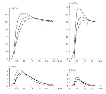
Bild 8 Die Bedeutung der Differenz zwischen der Laufzeit  $\tau_{\rm f}$  und der Retentionszeit  $\tau_{\rm f}$ , dargestellt an den Sprungantworten einer PI-geregelten Stauhaltung (A = 900 000 m²)
