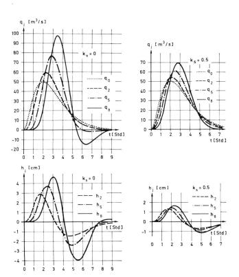
Bild 7 Stauregulierung in der Kaskade: Verbesserung der reinen Pl-Regelung (links) durch eine zusätzliche Störgrössenaufschaltung (rechts).
