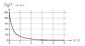
Bild 5 PI-Regelung: Aufschaukelung des maximalen Abflusses q<sub>max</sub> gegenüber dem konstanten Wert a der sprungförmigen Zuflussänderung (f(t), in Abhängigkeit vom Dämpfungsfaktor D
