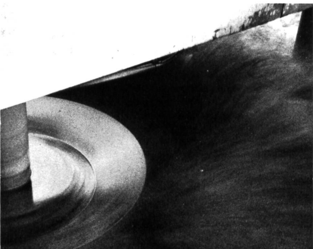
Bild 9 Mit hoher Umdrehungsgeschwindigkeit mischt der «Superquirl» Luft unter das Wasser.
