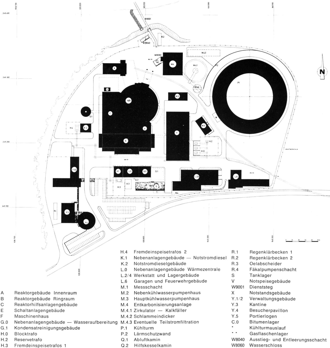
Bild 2 Uebersichtslageplan des Kernkraftwerks Gösgen; Massstab 1:1000 (Projekt Motor-Columbus Ingenieur-Unternehmung AG, Baden).
