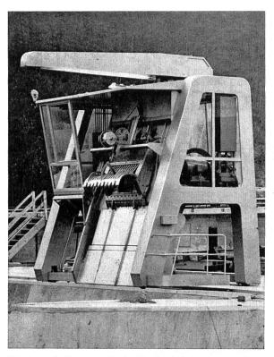
Fahrbare, halbautomatische Rechenreinigungsmaschine des Kraftwerks Schaffhausen
