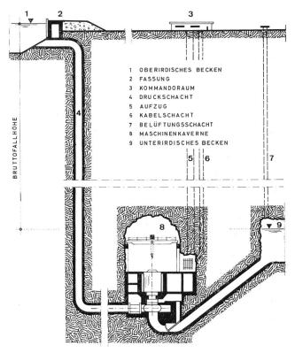
Schematischer Querschnitt durch ein einstufiges unterirdisches Pumpspeicherwerk.
