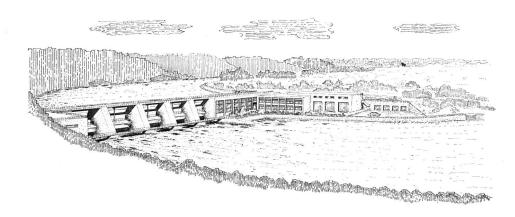
Bild 1 Perspektive Wehr, Maschinenhaus und Unterwerk des Reusskraftwerkes Bremgarten-Zufikon; Ansicht vom Unterwasser
