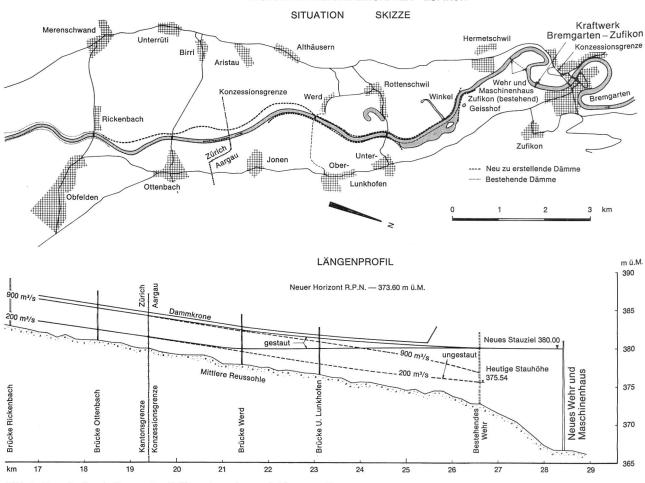
Bild 2 Reusskraftwerk Bremgarten-Zufikon, Lageplan und Längenprofil.
