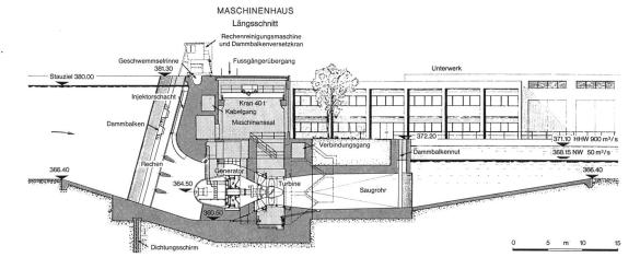
2 Rohrturbinen: Laufraddurchmesser 3.80 m Schluckvermögen je 100 m3/s ie 13 700 PS Leistung Drehzah! 150 U/min. 2 Dreiphasen-Leistung Generatoren: (bei cosphi 0.95) ie 10 000 kVA Spannung 4,25 kV 2 Transformatoren: Leistung 10 000 kVA Uebersetzung 4,25/17,1 kV
