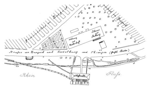
Bild 1 Schiffmühle Zurzach 1857. Aus dem Plan ist die Anordnung der zwei unterschlächtigen Wasserräder und die Verankerung der Schiffmühle erkennbar. In dieser Zeit wurde offenbar der Mahlvorgang auf der Mühle selber abgewickelt. Aus einem Plan aus dem Jahre 1881 geht hervor, dass dannzumal am Ufer ein Mühlengebäude bestand, wobei die Kraft von den Wasserrädern über Zahnräder und Gestänge übertragen wurde.
