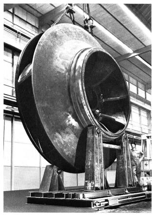
Das Bild zeigt das Laufrad der Pumpenturbine, das für das Kraftwerk Vouglans (Ain) der EdF bestimmt ist. Dies ist die grösste Pumpenturbine Europas und die erste in Frankreich. Es ist eine frankoschweizerische Verwirklichung, zu der die ACMV einen grossen Teil beigetragen hat.
