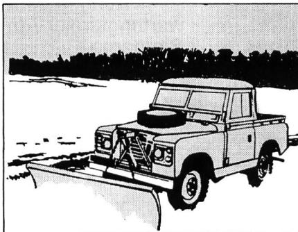
Ein unermüdlicher «Champfer» auf dem Bauernhof: der **Land Rover 88 mit kurzem Radstand**. Er schleppt und transportiert und zieht und stößt und hebt in jedem Gelände, unter härtesten Bedingungen, pausenlos! Als Chassis oder mit 12 verschiedenen Aufbauten lieferbar. Nutzlast (Strasse): 3 Personen plus 406 kg. Anhängelast: 5 Tonnen.
