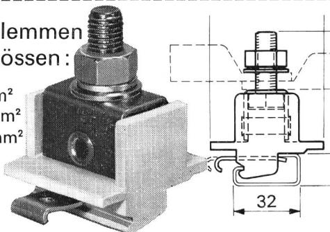
Zum Aufsetzen auf Tragschiene nach DIN 46277/1 mit Verriegelung. Mit unzerbrechlichem Isolierkörper aus Polyamid 6.6, temperaturbeständig von -30° C bis +100° C. Bolzen und Metallgarnitur aus rostfreiem Stahl. Leiter gegen selbstlockern gesichert.
