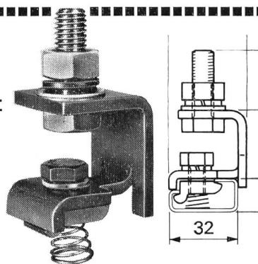
Ebenfalls zum Aufsetzen auf Tragschiene nach DIN 46277/1 mit Nutenstein. Klemmbügel aus Kupfer-Speziallegierung. Bolzen, Schrauben und Federn aus rostfreiem Stahl. Leiter und Verbindung auf Profilschiene gegen selbstlockern gesichert.
