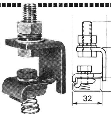
Ebenfalls zum Aufsetzen auf Tragschiene nach DIN 46277/1 mit Nutenstein. Klemmbügel aus Kupfer-Speziallegierung. Bolzen, Schrauben und Federn aus rostfreiem Stahl. Leiter und Verbindung auf Profilschiene gegen selbstlockern gesichert.
