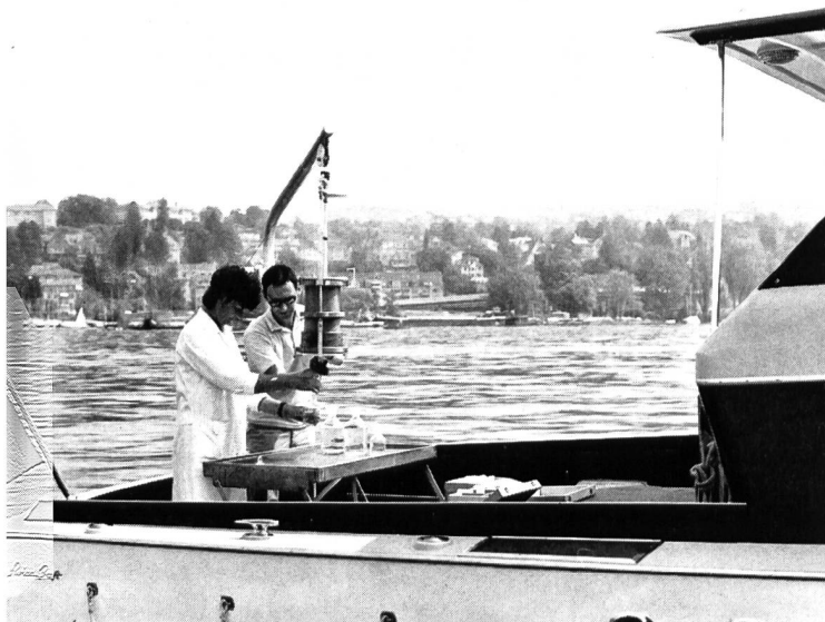
Bild 7 Die Wasserproben-Entnahmen erfolgen mittels einer 5-Liter-Schöpfflasche.
