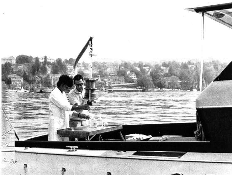
Bild 7 Die Wasserproben-Entnahmen erfolgen mittels einer 5-Liter-Schöpfflasche.
