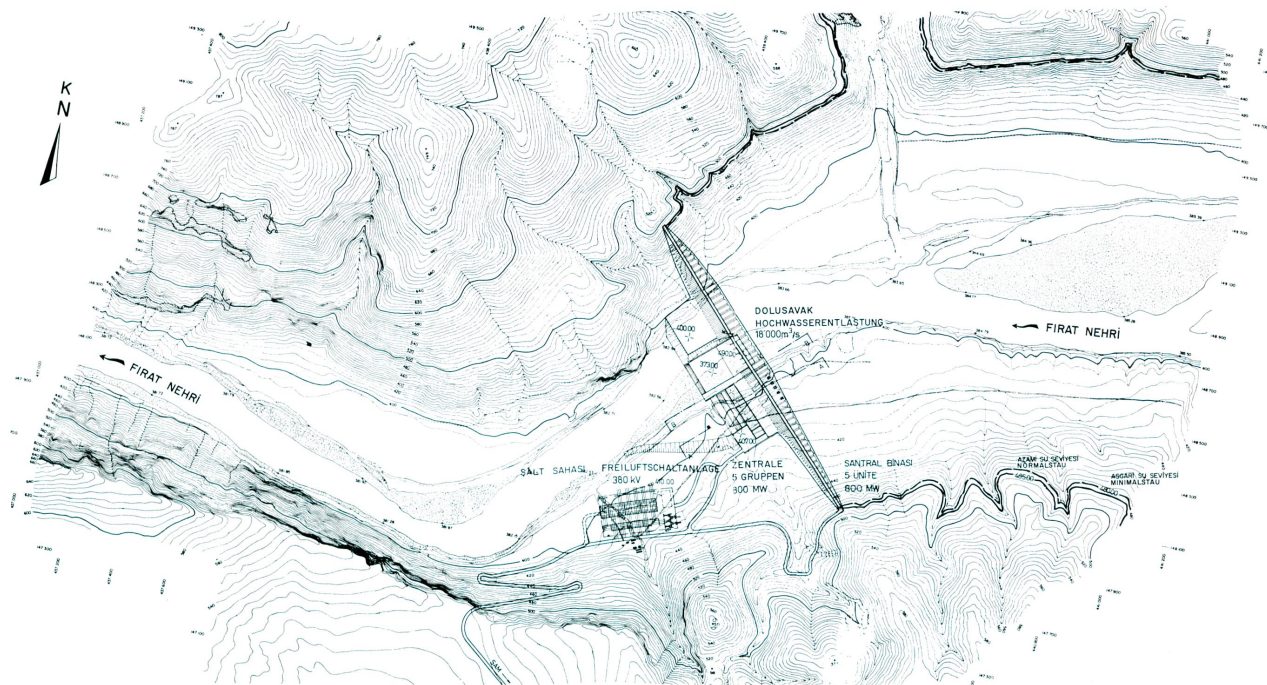
▲ Bild 9 Uebersicht des Gesamtprojektes mit Speicherbecken, Kraftwerken und Be- wässerungssystemen.
