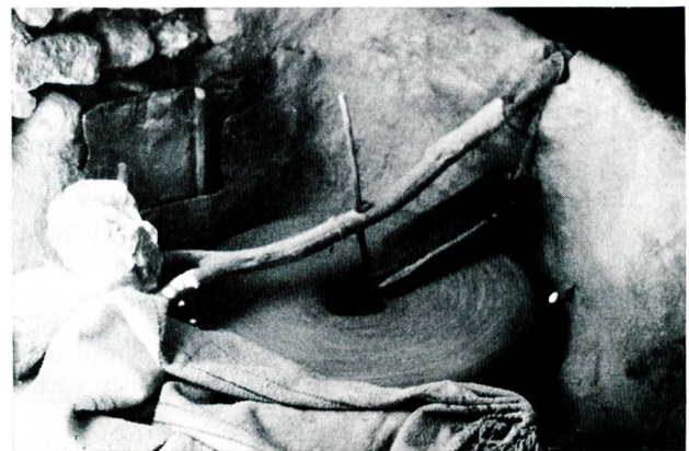
Bild 40 Mahlanlage mit schwingender Korneingabe im Mühlenkraftwerk Bend-e-Emir.
