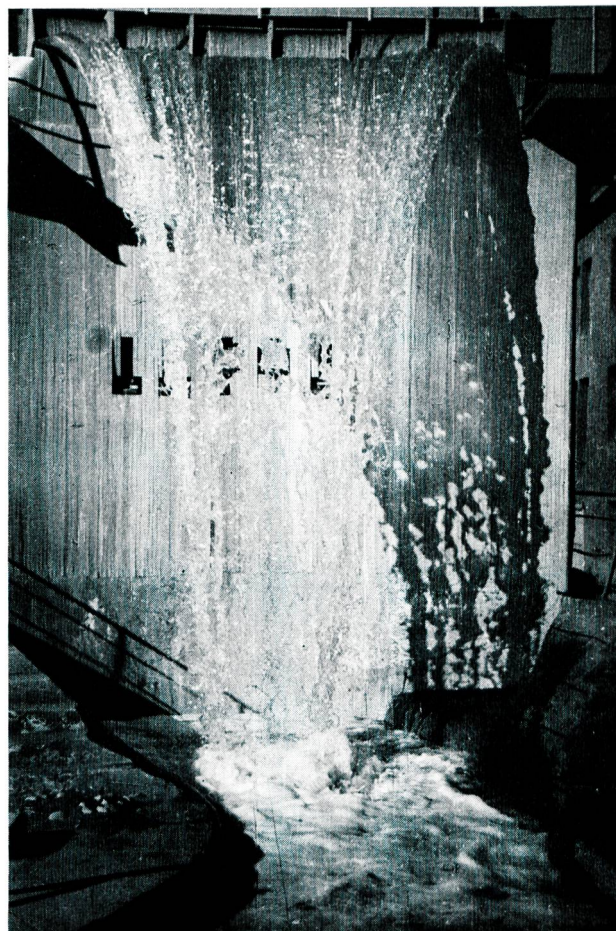
Bild 10 Wie Bild 9 nach Einbau von Strahlableitkernen in den beiden äusseren Öffnungen.
