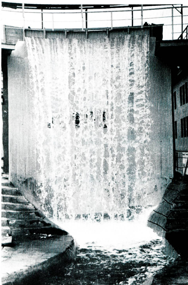
Bild 9 Modellversuch im Massstab 1:40 des Kronenüberfalls mit sechs Öffnungen von je 25 m für die Ableitung von 1800 m³/s.
