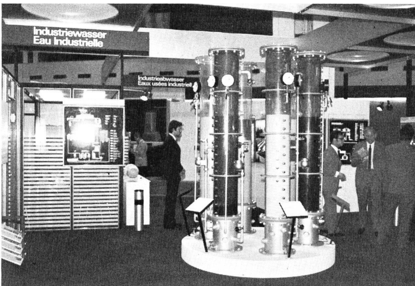
Bild 3 Ionenaustausch-Kreislaufanlage für Industrieabwasser
