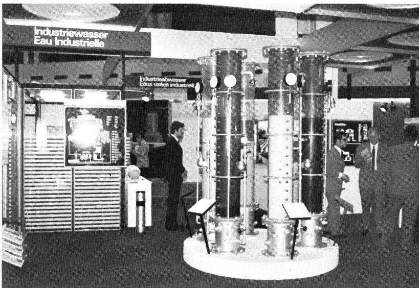
Bild 3 Ionenaustausch-Kreislaufanlage für Industrieabwasser
