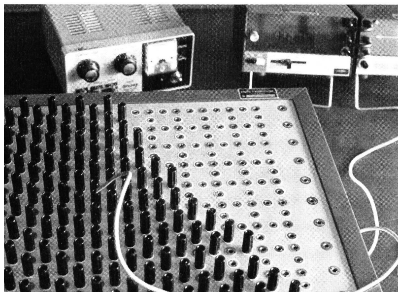
Fig. 3 Réseau de résistance permettant d'étudier les potentiels et les écoulements souterrains. (Centre d'hydrogéologie de l'Université de Neuchâtel)
