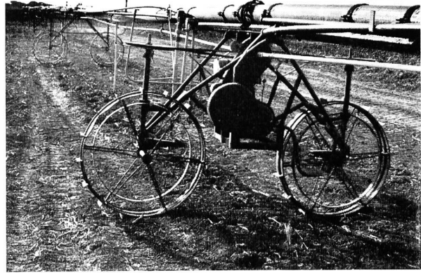
Bild 3 Mobile Berechnungsanlage in den drainierten Gebieten der Camargue bei Souteyranne; Befeuchtung des Bodens und Auswaschung des Meersalzes
