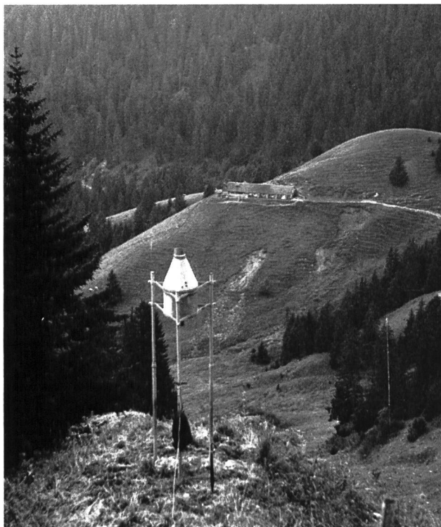
Bild 13 Einzugsgebiet der Baye de Montreux — Totalisator Creux du Marais mit hangparalleler 28°20' geneigter Auffangfläche, in windausgesetztem WSW-Hang auf 1665 m ü. M.
