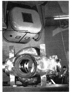
Pumpengehäuse für das Atomkraftwerk «Gundremmingen» bei der Röntgenprüfung mit dem Betatron, Gewicht 20 t.
