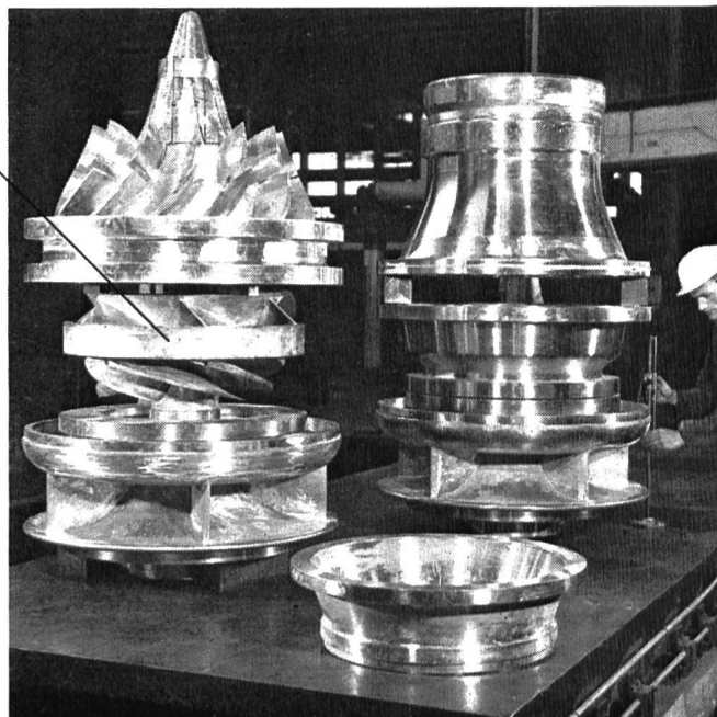
Sekundärpumpen für das natriumgekühlte Prototyp-Schnellbrüter-Atomkraftwerk «Dounreay» (250 MWe). (Diffusor mit 3 Stufen à 13 Schaufeln — Pumpenrad mit 6 Schaufeln — Einlaufsaugstück — Diffusormantel — Radmantel — Radkranz.) Gesamtgewicht pro Garnitur 2400 kg.
