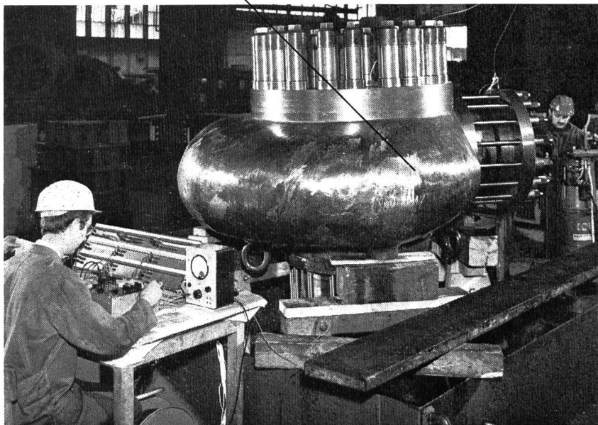
Pumpengehäuse von 9,1 t Gewicht für das 600 MW Atomkraftwerk «Würgassen» bei der Spannungs-Dehnungsmessung unter Betriebsdruckbedingungen von 170 atü zusammen mit dem Kunden und der staatlichen Abnahmebehörde. Geliefert an: KSB-Klein, Schanzlin & Becker, Frankenthal/Deutschland
