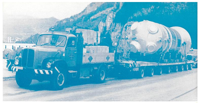
Transport eines 140 t schweren Dampferzeugers von Basel, Auhafen nach dem Atomkraftwerk Beznau 2. Zwei gleiche Traf porte im Frühling 1970. Transportgewicht 140 Tonnen. Das Anhänger-Gesamtgewicht nur 180 Tonnen. Unsere Spezialität: leichteste und modernste Fahrzeuge. Wir beanspruchen die Brücken weniger als jeder andere Transpo unternehmer. Wir haben die modernsten, leistungsfähigsten und leichtesten Schwertransportfahrzeuge Europas. 16 Achslinien auf 21 m Fahrzeuglänge!
