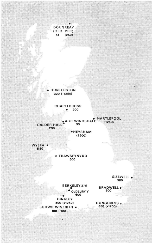
Bild 7 Standorte der in Grossbritannien bestehenden und geplanten Kernkraftwerke. Die Zahlen geben die elektrische Kraftwerkleistung in MW an. Zahlen in Klammern: im Bau. Quelle: Prospekt der UKAEA
