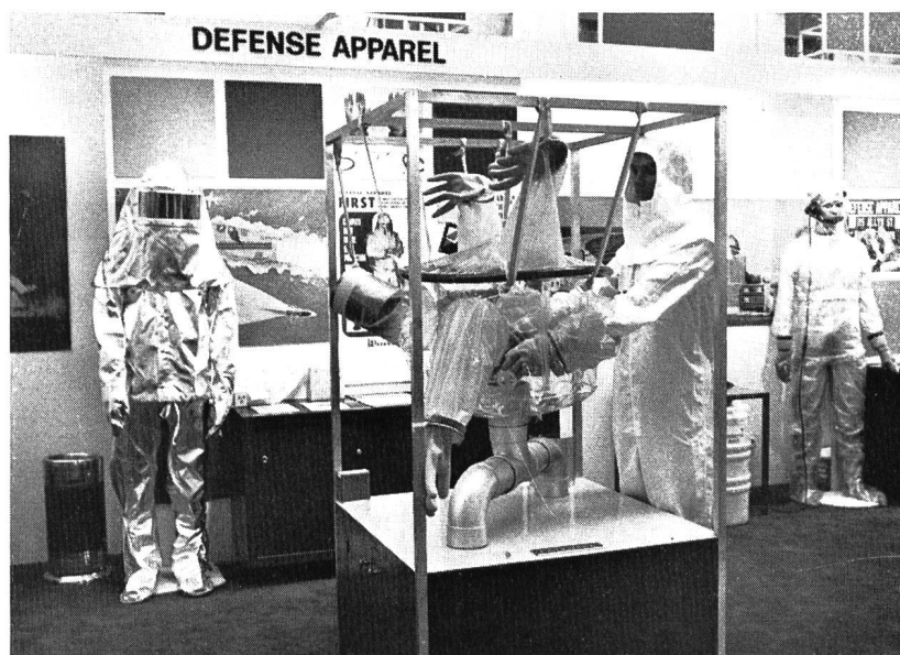
Bild 10 Schutzgehäuse für Arbeiten an strahlenden oder giftigen Ob- jekten Foto: Dierks, Basel
