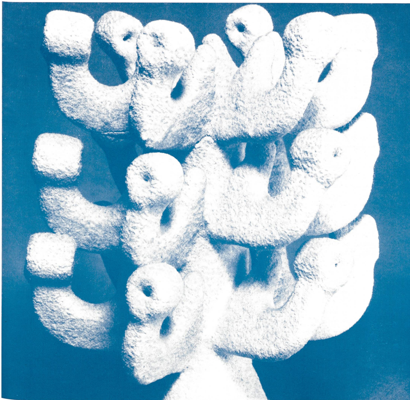
Sulzer-Präzisionsguss-Verfahren: Hohlform aus keramischer Masse für 18 Mikrometerbügel im Stückgewicht von 120 Gramm
