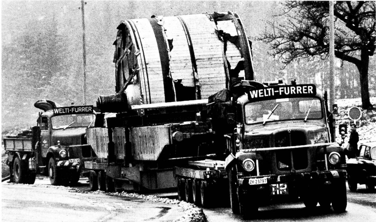
Transport eines Glättezylinders von 70 Tonnen Gewicht. Die Abmessungen betragen: Durchmesser 4,8 m, Höhe 5,1 m, Gesamtlänge des Konvois 43 m, Totalgewicht 116 Tonnen.
