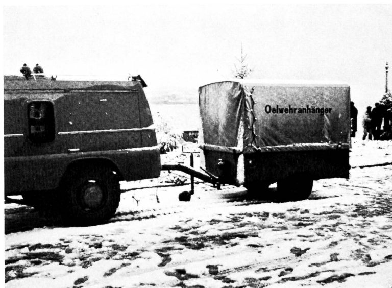
Bild 3 Oelschaden-Anhänger, die bei den Luzerner Stützpunkten Hochdorf, Sursee, Willisau und Wolhusen in Betrieb stehen
