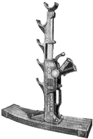
Simplex Nr. 321 für Trommeln von 50-240 cm Ø, Tragkraft 10 t, wiegt 52 kg mit Fundament. Für Kabelwagen oder grössere Trommeln sind Spezialwinden und hydr. Heber bis 45 t lieferbar.
