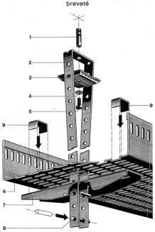
Nouveau dispositif mobile et central pour suspension aux plafonds. Plus d'enfilage. Les câbles s'introduisent tout tendus, sans être gênés par des suspensions latérales. Temps de posage abrégé et montage facile. également par personnel non spécialisé. Pas besoin d'outils spécialux.
