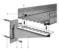
Les dispositifs de fixation sont normalisés pour le montage au plafond et à la paroi. Les chemins de câbles HEER sont livrables en 5 largeurs: 140, 210, 280, 350 et 420 mm, avec tous accessoires, soit coudes horizontaux et verticaux, pièces T et + avec réductions et embranchements de 0 à 90°, équerres et pièces d'arc intérieures et exterieures. Raccordement simple et rapide des chemins de câbles HEER, indépendants des fixations, soit aux parois, soit aux plafonds.
