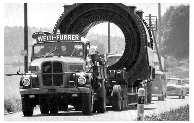
Transport eines Stators der Maschinenfabrik Oerlikon von 87 t Gewicht, 5,7 m Länge, 4,2 m Breite und 3,7 m Höhe für das Unterkraftwerk Breite / Nürensdorf der Nordostschweizerischen Kraftwerke.
