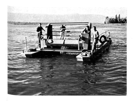
Prototyp eines mit 2 motorisierten Schwimmern ausgerüsteten Feinrechens mit Rechenreinigungsmaschine für die Entfernung von jeglichen Schwimmstoffen von der Oberfläche der Gewässer, insbesondere Seen, Staugebieten usw. (Unter Schwimmstoffen verstehen sich: Algen, Schlamm, Schilf, Plastikmaterial, Flaschen, Holz und dergleichen.) Patentiertes System
