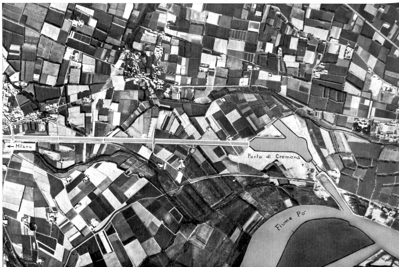
Bild 3 Luftbild der Umgebung der in der Po-Ebene gelegenen Stadt Cremona mit Po, Vorhafen, Schleuse, Hafenbecken und nach Mailand abgehendem Kanal.
