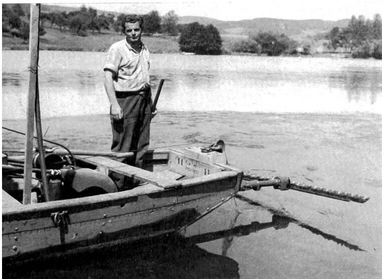
Bild 9 Algenfräse Kraftwerk Rheinau 1967; starkes Eisenboot mit Hydraulik und Bucher-Egge als Fräsgerät
