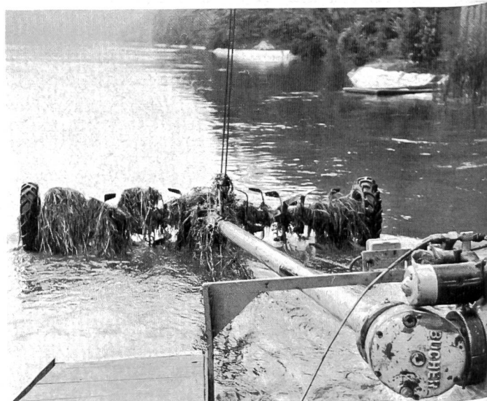
Bild 10 Kraftwerk Rheinau, Algenfräse in Betrieb
