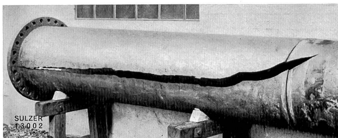
Bild 1 Rohrbruch einer wassergasgeschweissten, im Jahre 1908 erstellten Verteilleitung.
