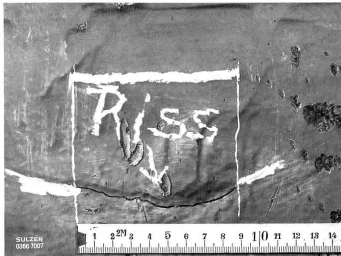
Bild 6 Durch Hämmern beim Wassergasschweissen zertrümmertes Material mit einem 90 mm langen Riss.
