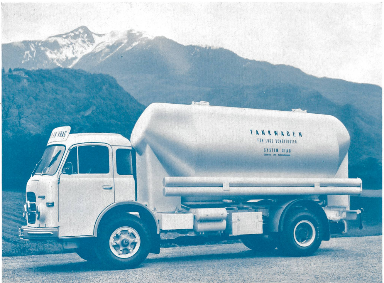
Silowagen 16 m 3 Nutzinhalt, System STAG aus Leichtmetall für staubförmige und körnige Schüttgüter wie Mehl, Futtermittel, Gries, Chemikalien u.a.m. Komplett mit Gebläse für pneumatischen Entlad
