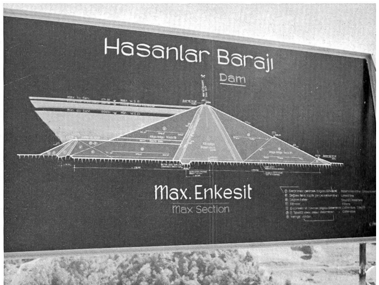
Bild 34 Plan des Querschnitts für den Staudamm Hasanlar in der Nähe des Schwarzen Meers.
