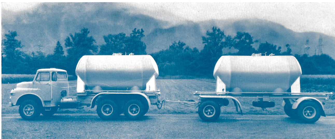
STAG-Anhängerzug auf 5 Achsen. Spezialkonstruktion für die Türkei. 36 t Gesamtgewicht, 24 t Nutzlast, 2 Aluminiumbehälter. Einsatzort: Keban-Damm, Türkei.
