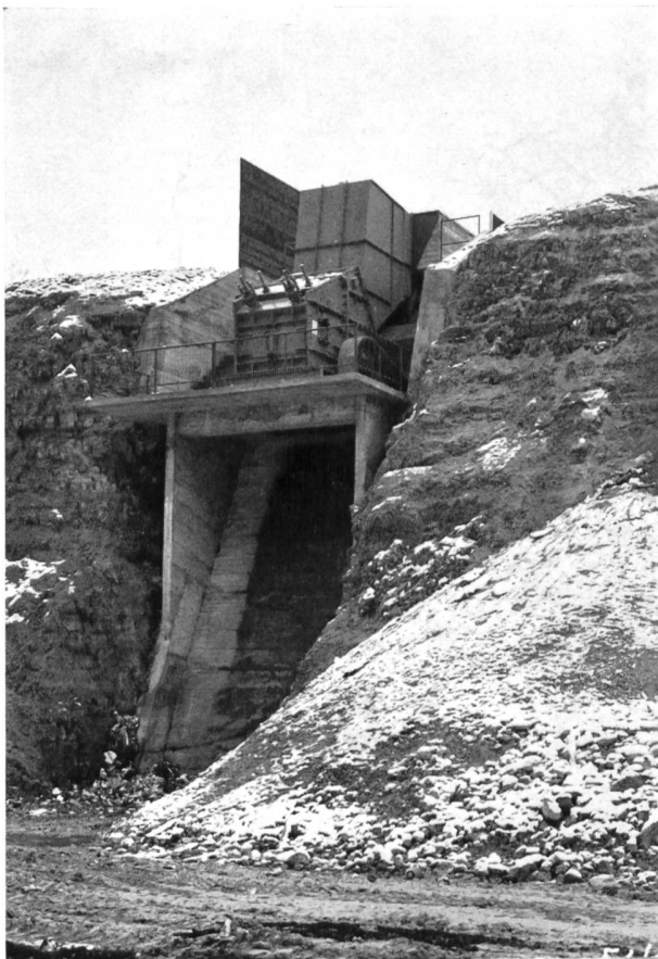
Bild 4 Prallmühle im Steinbruch Würenlingen zur Zerkleinerung des Sperrmülls der Region Baden-Brugg. (Photo Hazemag Münster)
